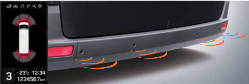
El sistema PAS utiliza sensores ubicados, delante y detrás, para detectar posibles obstrucciones al estacionar. ( opcional )
