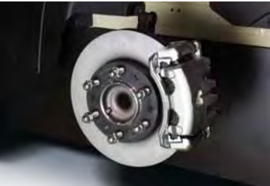
Frenos de disco en las 4 ruedas para un frenado constante y equilibrado
